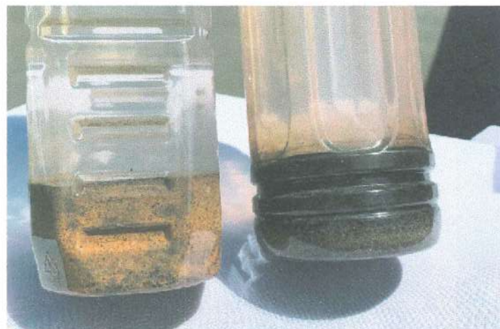
大型トラック 1 台の DPR から出たアッシュ。右は予備洗浄で出た煤が混ざったアッシュ。左は洗剤による洗浄後に出てきたアッシュ。
